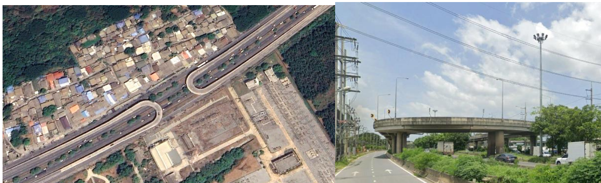
รูปที่ 7.3-2 ตัวอย่างรูปแบบจุดกลับต่างระดับ
